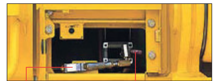
Pistola de graxa Acessível ao nível do solo Indicador
